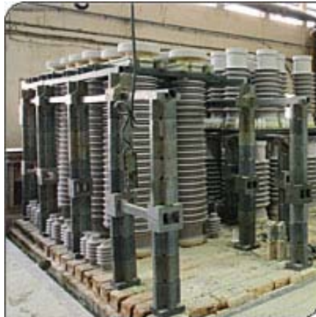
Sl.4. Prikaz izolatora pripremljenih za proces pečenja na vagonu peći
